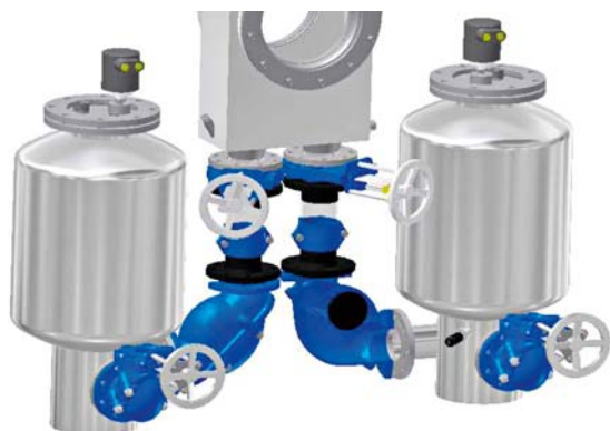
Rys. 4 Pneumatyczna tłoczni ścieków, typ EPP
